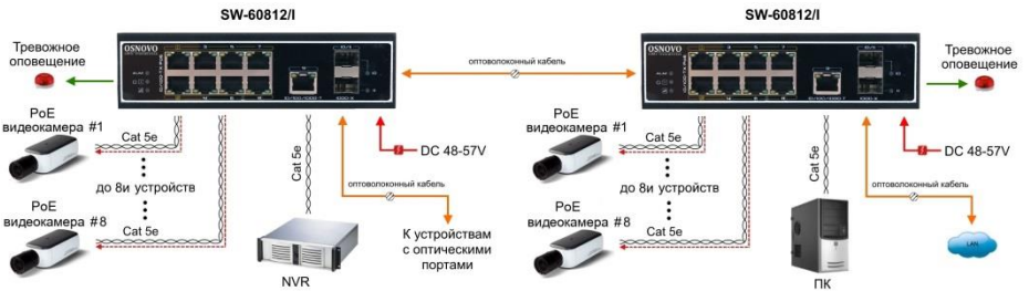
Рис.5 Схема каскадного подключения коммутатора SW-60812/I
